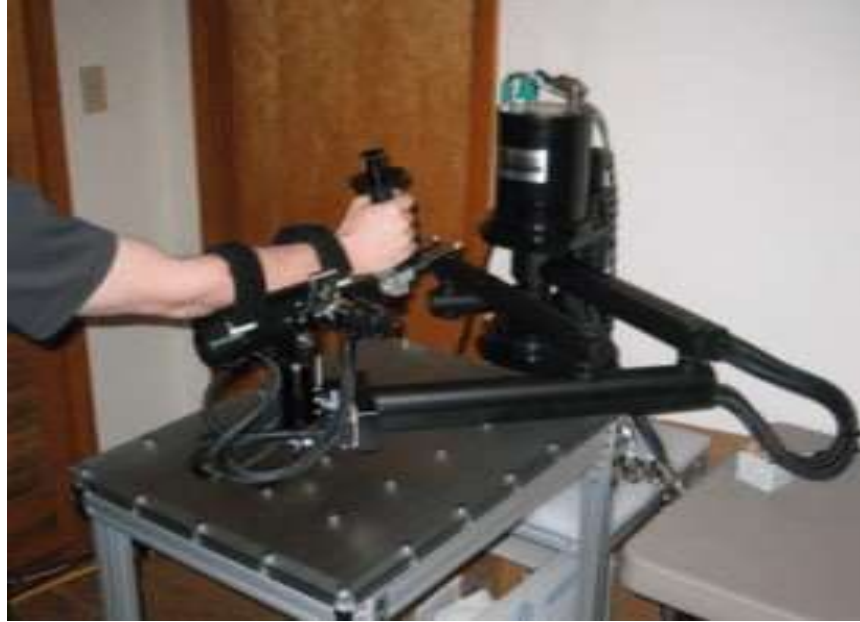
Εικόνα 1: Ρομποτικό μέσο Τελικού-Τελεστή (Islam Md Rasedul, 2017)
