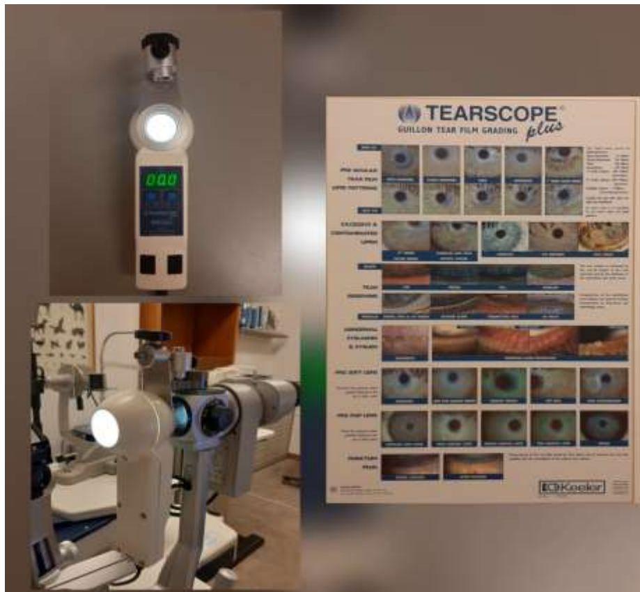
Εικόνα 10: Απεικόνιση α) Tearscope β) Tearscope τοποθετημένο στην σχισμοειδή λυχνία γ) Πίνακας κλίμακας βαθμολόγησης Guillon
