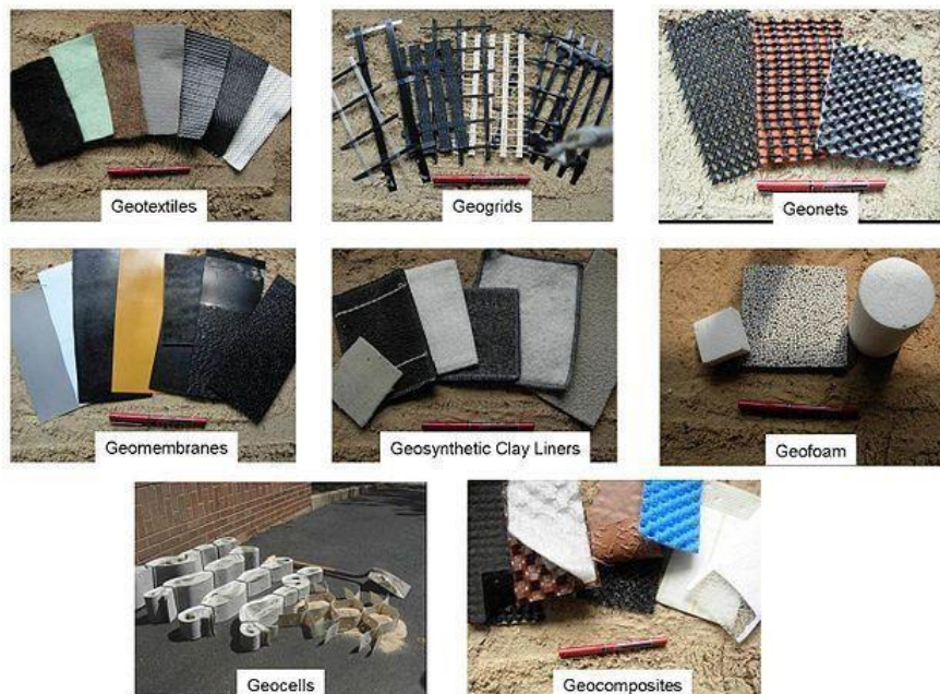
Εικόνα 1.1 Απεικόνιση των διαφόρων ειδών των γεωσυνθετικών υλικών
