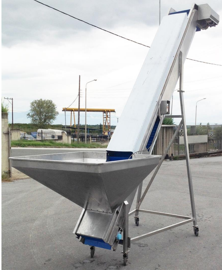
Εικόνα 2: Χοάνη παραλαβής και αναβατόριο τροφοδοσίας
