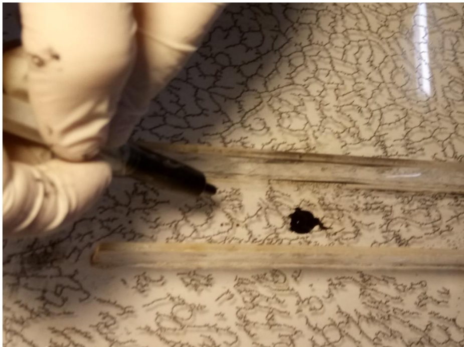
Εικόνα 14: Υπολογισμός ταχύτητας με την χρήση σταγόνας χρώματος
