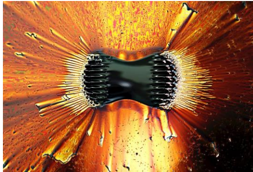
Εικόνα 4: Σιδηρορευστό που συλλέγεται στους πόλους του μαγνήτη που είναι κάτω από το λευκό δίσκο(Gregory F. Maxwell)
