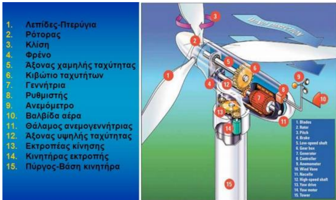
Εικόνα 4.1 : Μηχανικά μέρη μιας ανεμογεννήτριας
