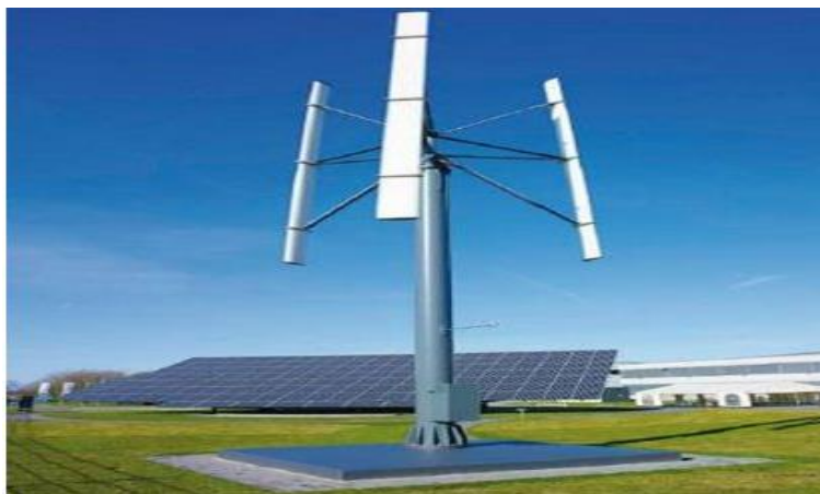
Εικόνα 4.3 : Ανεμογεννήτρια κατακόρυφου άξονα
