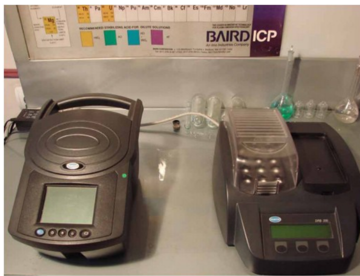
Εικόνα 2.5 : Συσκευή πέψης(δεξιά) και Φορητό φασματοφωτόμετρο (αριστερά) για τη μέτρηση του COD (Πηγή : https://web.archive.org )
