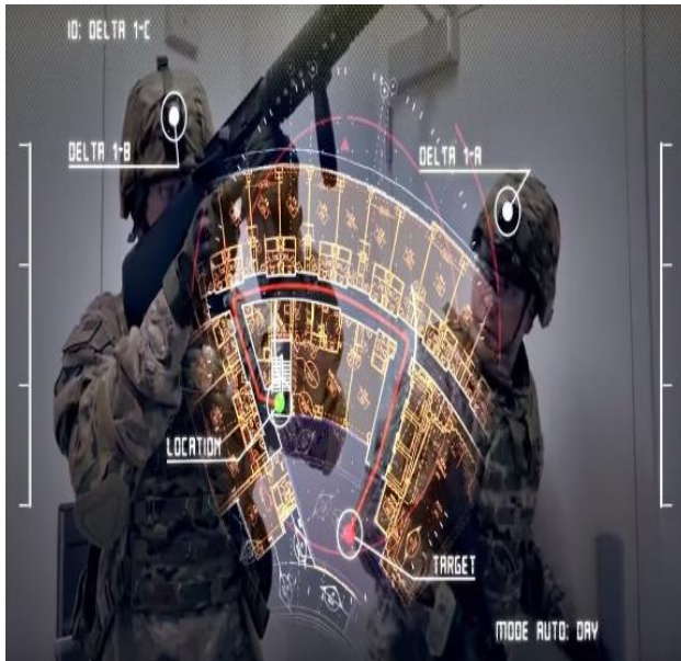
Εικόνα 3.13: Ο στρατός των Η.Π.Α. χρησιμοποιεί τακτική επαυξημένης πραγματικότητας που βοηθά τους στρατιώτες να εντοπίσουν με ακρίβεια τις θέσεις τους, καθώς και τις τοποθεσίες φίλων και εχθρών. Με μια συσκευή προβολής heads - up αντικαθιστά τόσο τα γυαλιά νυχτερινής όρασης όσο και το φορητό GPS.
