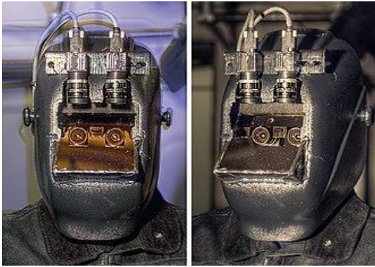
Εικόνα 9.1: Κράνος συγκόλλησης MannGlas (ψηφιακό γυαλί ματιών) εφαρμόζει απεικόνιση υψηλής δυναμικής εμβέλειας για να αυξήσει την εικόνα σε σκοτεινές περιοχές και να την μειώσει σε φωτεινές περιοχές.
