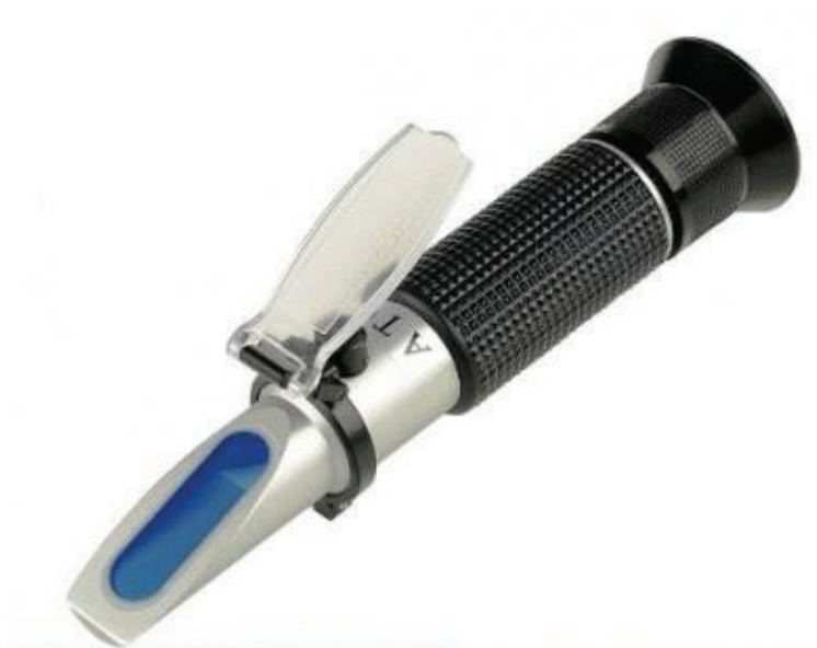
Εικόνα 2.1. Τύπος φορητού διαθλασίμετρου που χρησιμοποιήθηκε στην παρούσα εργασία ακρίβειας 0,1%.
