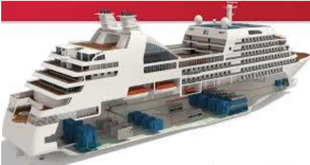
Εικόνα 15: Κατανομή του συστήματος ντιζελοηλεκτρικής πρόωσης, σε όλη την καρίνα του πλοίου, [AEN Μακεδονίας]
