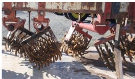
Περιστροφικά σκαλιστήρια με κλίση ως προς την κατεύθυνση κίνησης
