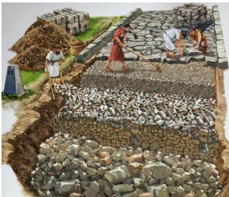
Εικόνα 2. Οδοστρώση αρχαίων ρωμαϊκών δρόμων
