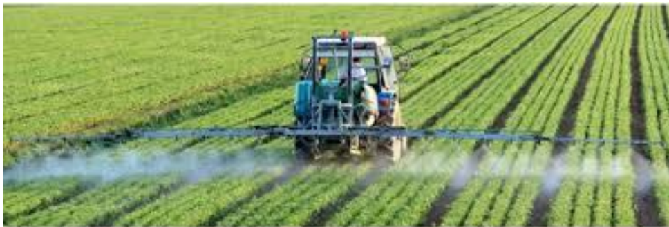
Εικόνα 18 : ψεκαστικό στο πίσω μέρος φαίνεται ο ιστός με τα μπεκ
