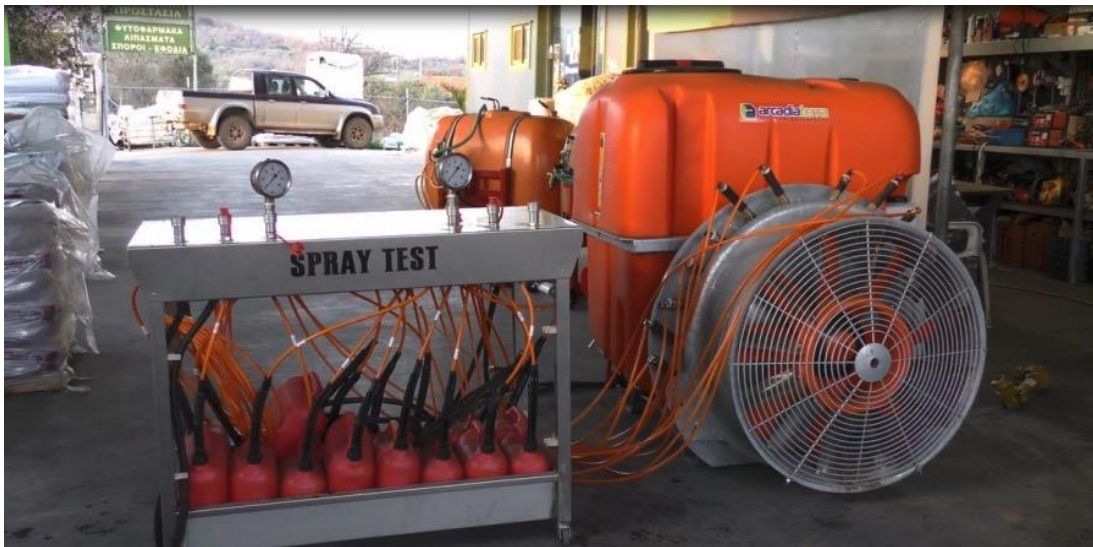
Εικόνα 26 : Τράπεζα μέτρησης παροχών ακροφυσίων ψεκαστικού στην οποία δεν απαιτείται η αφαίρεση των ακροφυσίων
