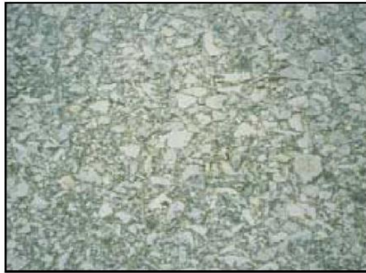
Εικόνα 32: Λείανση επιφανειακών αδρανών (17)
