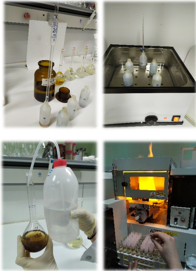
Εικόνα 30: Προσθήκη CBD στο δείγμα, Εικόνα 31: Υδατόλουτρο, Εικόνα 32: Συμπλήρωση τελικού όγκου, Εικόνα 33: Μέτρηση οξειδίων στην ατομική απορρόφηση
