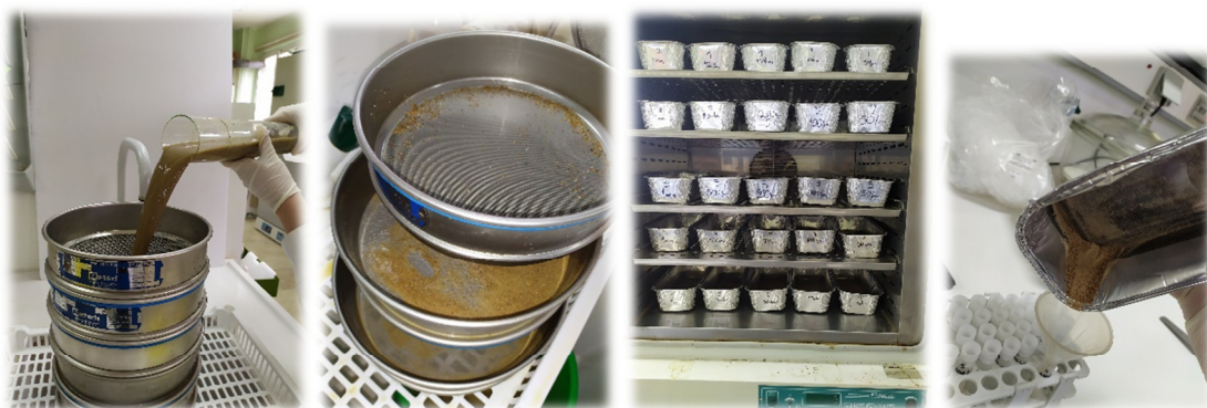
Εικόνα 29: Κλασμάτωση, Αεροξήρανση, Αποθήκευση της άμμου
