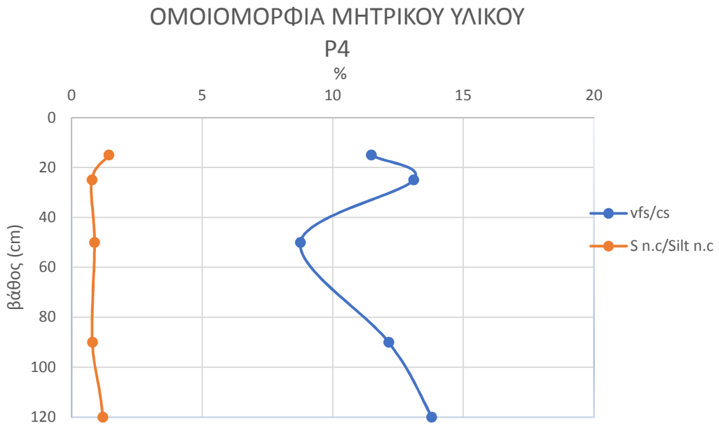
Διάγραμμα 39: Περιγραφή ομοιομορφίας μητρικού υλικού για το προφίλ 4
