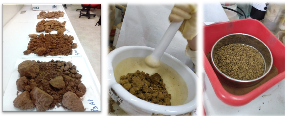
Εικόνα 3: Μέθοδος αεροξήρανσης εδαφών, Εικόνα 4: Τρόπος λειοτρίβησης εδαφικών τεμαχιδίων, Εικόνα 5: Κοσκίνισμα του δείγματος
