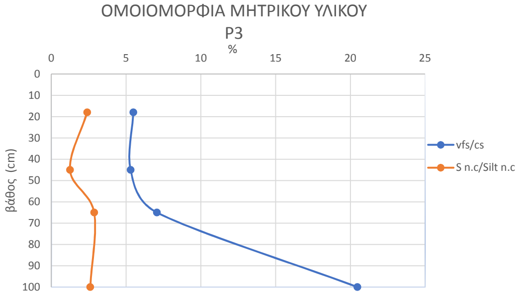
Διάγραμμα 38: Περιγραφή ομοιομορφίας μητρικού υλικού για το προφίλ 3
