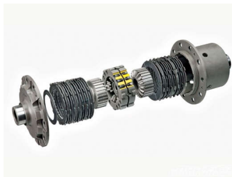
Εικόνα 3.2: Διαφορικό περιορισμένης ολίσθησης με πολύδισκους συμπλέκτες (Autoblog)
