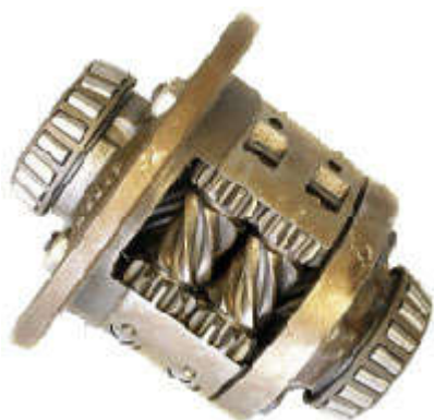
Εικόνα 3.5: Διαφορικό τύπου Torsen (Magnus Motorsports)
