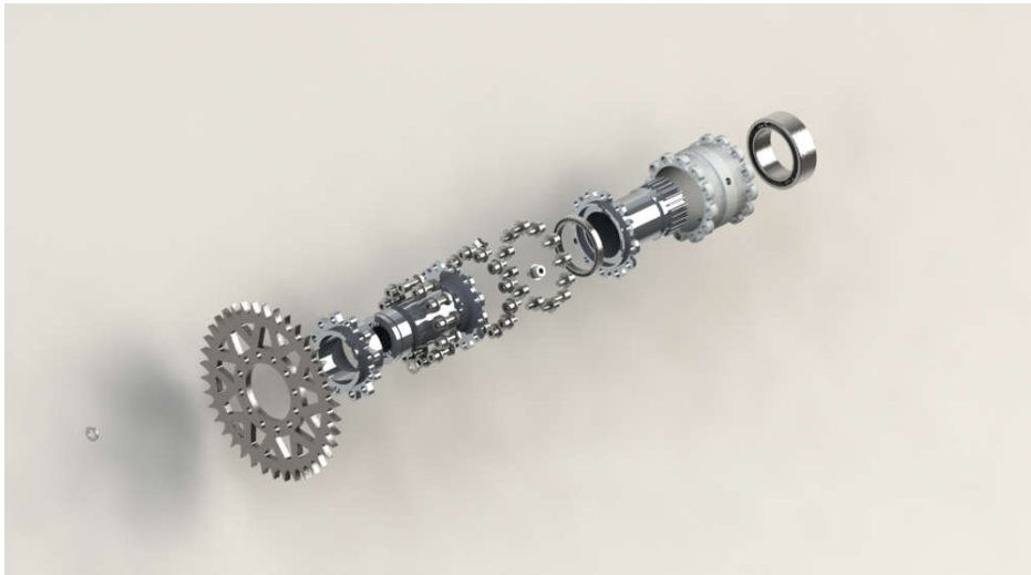
Εικόνα 3.4: Διαφορικό τύπου Salisbury (Multibody)
