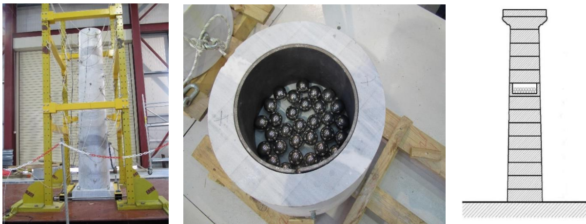
Εικ.33 Μοντέλο σφονδυλωτού κίονα με την χρήση αποσβεστήρα σωματιδίων, Papalou, et al. (2015)
