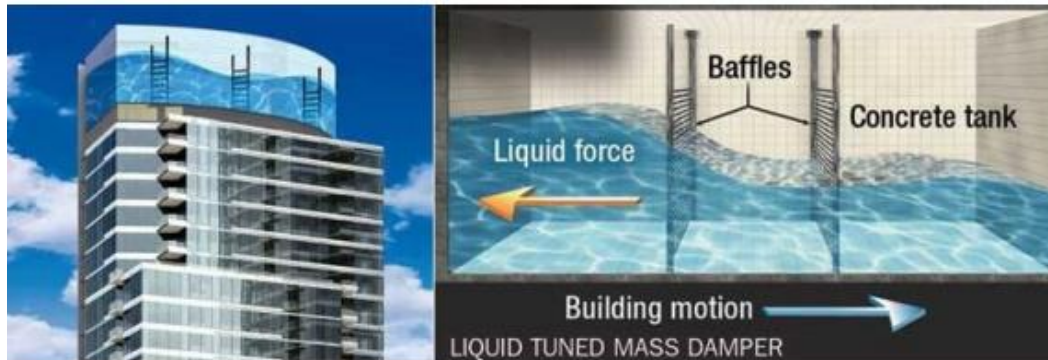
Εικ.29 Μοντέλο One Rincon Hill South Tower 2008, συντονισμένη ρευστή διάταξη απόσβεσης ( http://artemis.library.tuc.gr/ )
