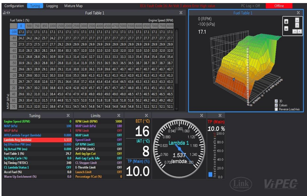
Εικόνα 1.2 : Ενδεικτική απεικόνιση χαρτογράφησης κινητήρα της LINK ECU
