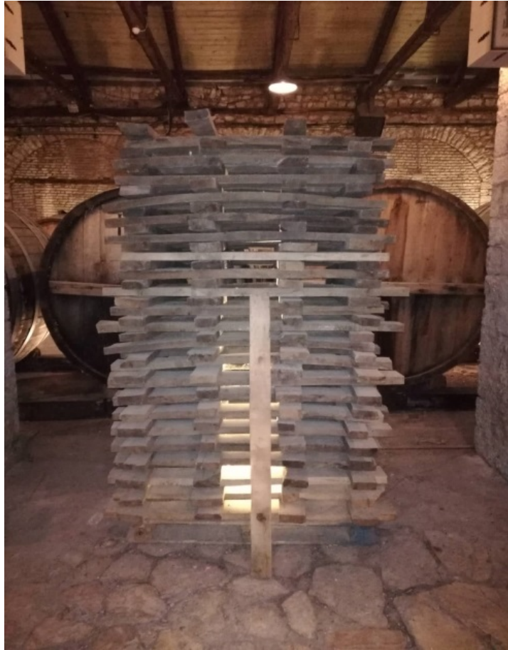
Εικόνα 20: Ο τρόπος που τοποθετούσαν τις σανίδες της δρυός
