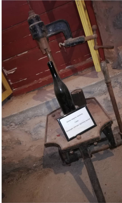
Εικόνα 62: Ταπωτική Μηχανή (αριστερά) Τράπεζα αναμονής φιαλών (δεξιά)
