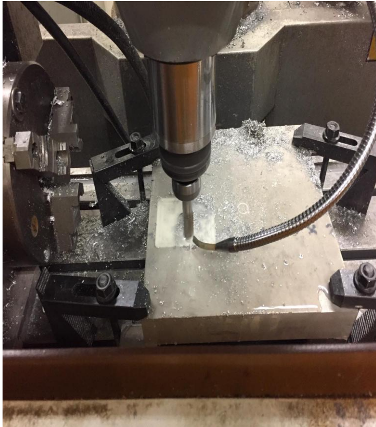
Σχήμα 6.9: Αρχικό στάδιο κοπής της βάσης με χρήση εργαλειομηχανής CNC.
