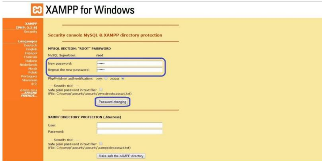
Εικόνα Π1.19: Security Console: Εισαγωγή κωδικού ασφαλείας για τον διαχειριστή της MySQL
