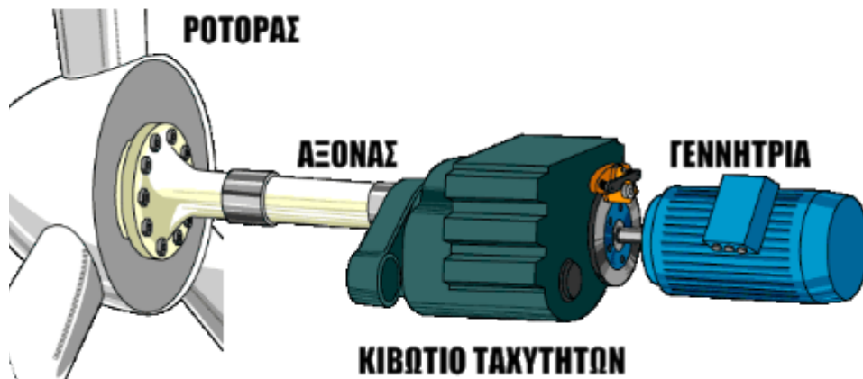
Εικόνα 3-4 Το εσωτερικό της ανεμογεννήτριας
