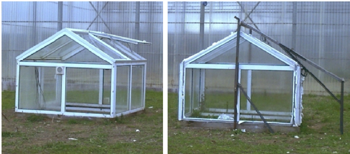
Εικόνα 4.1: Πειραματικά θερμοκήπια με και χωρίς φωτοβολταϊκά στην οροφή τους αντίστοιχα
