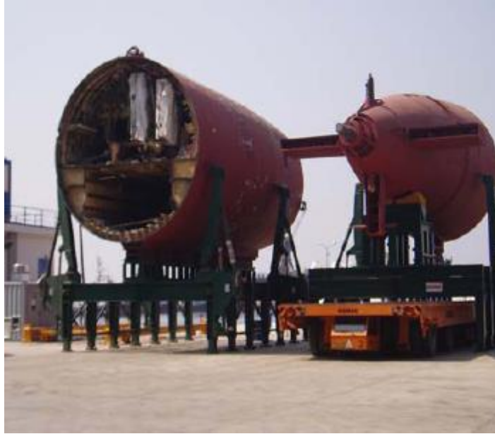
Εικόνα 61: Τμήματα Υ/Β ΩΚΕΑΝΟΣ μετά την κοπή του ανθεκτικού σκάφους
