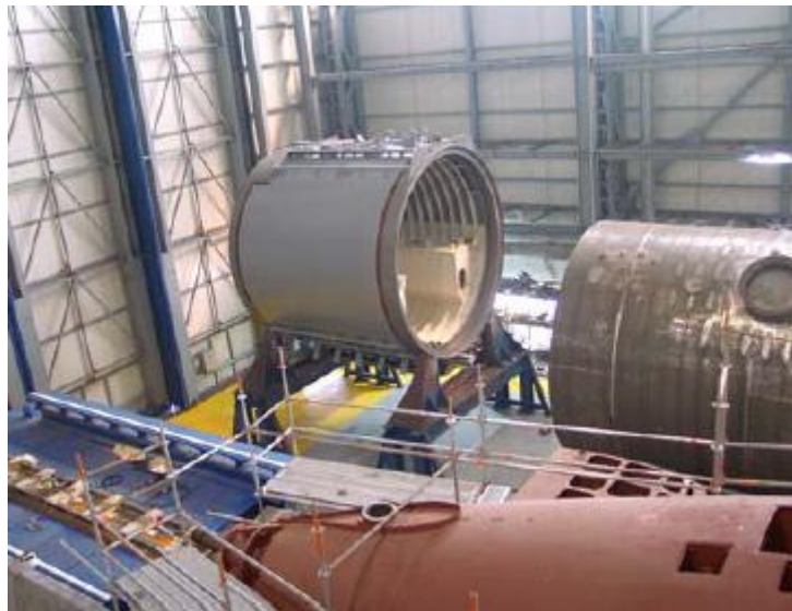
Εικόνα 64: Τμήμα Α.Ι.Ρ μετά την αμμοβολή/βαφή και πριν τον εξοπλισμό
