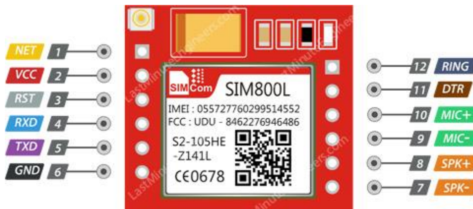
Εικόνα 24 SIM800L module pins
