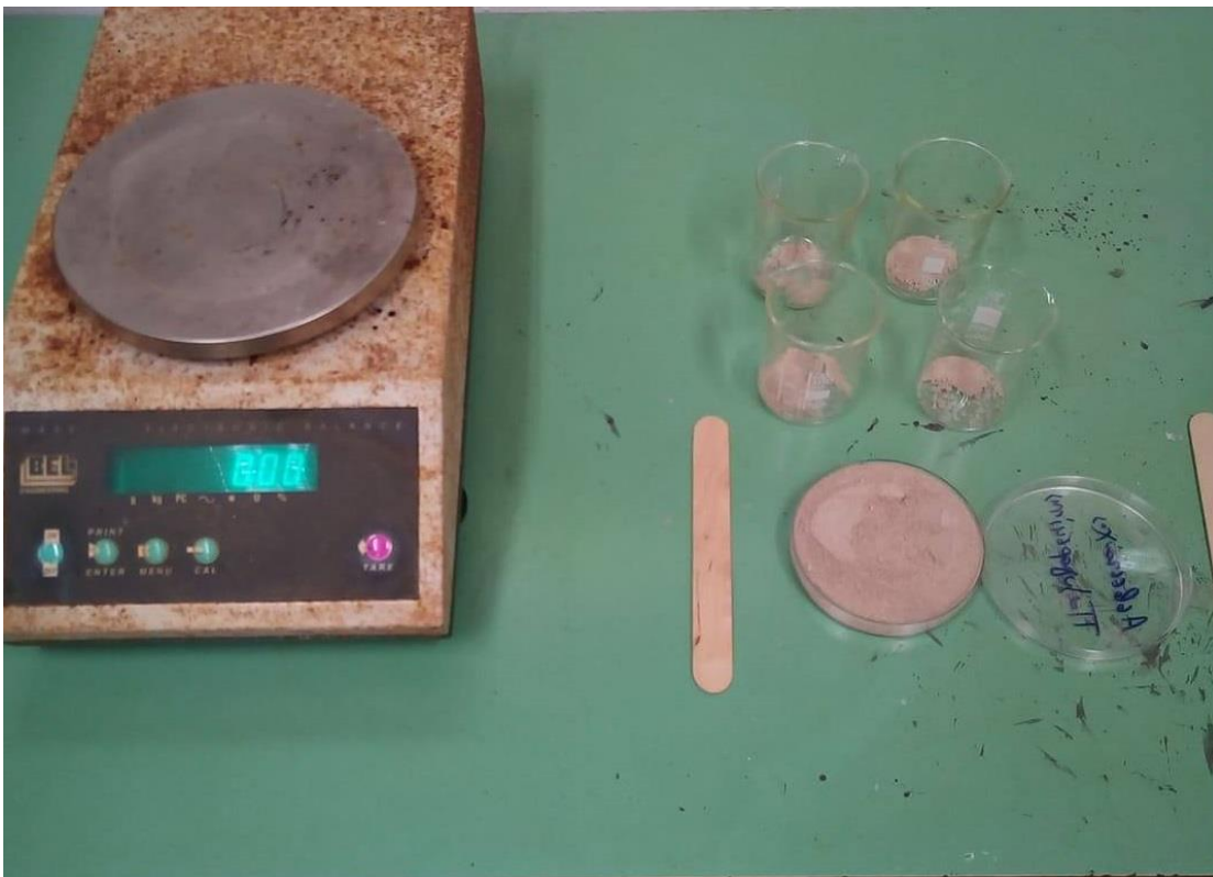
Εικόνα 2: Ηλεκτρονικός ζυγός ακριβείας για ακριβή μέτρηση του κάθε δείγματος
