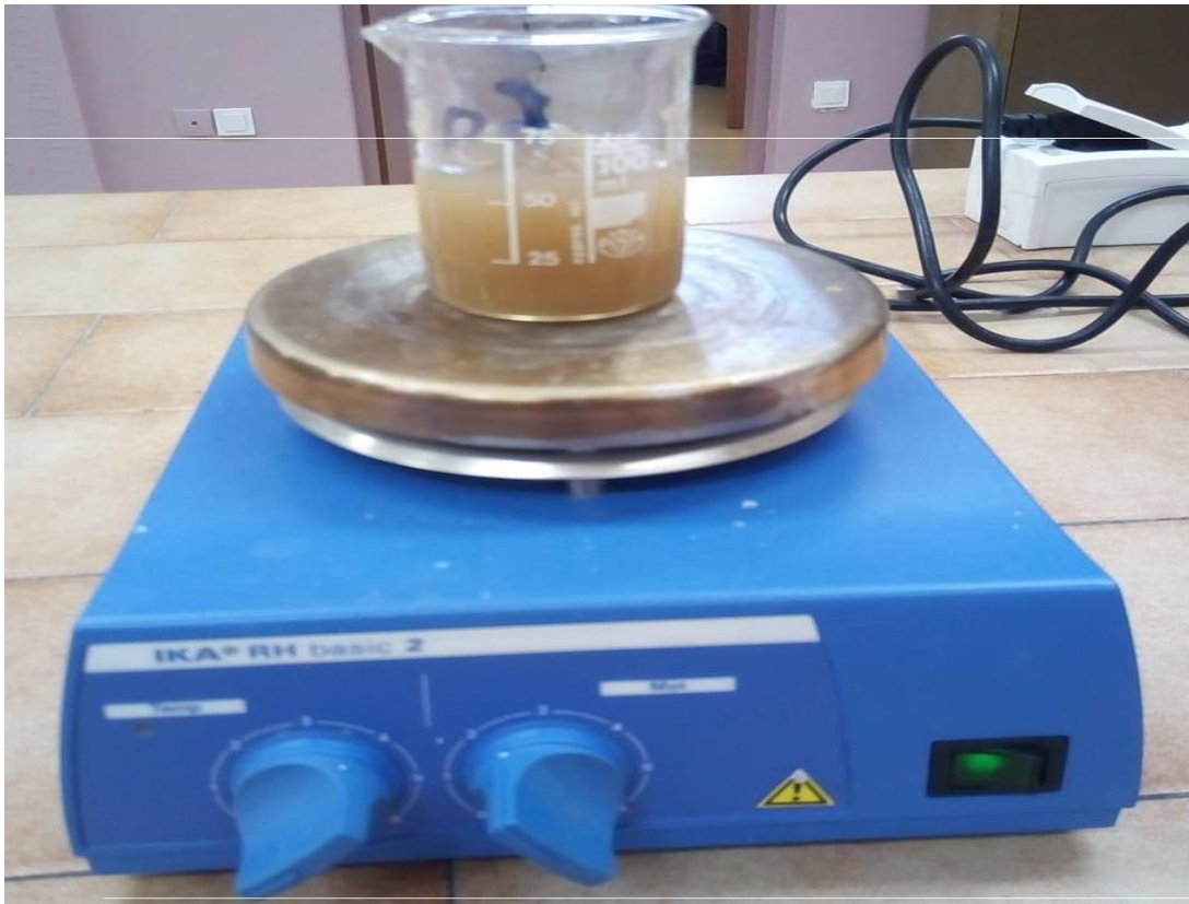
Εικόνα 3: Μαγνητικός αναδευτήρας για την επιτυχημένη ομογενοποίηση των δειγμάτων
