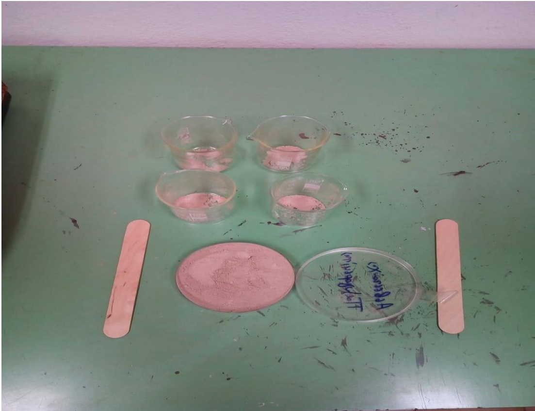
Εικόνα 1: Κονιοροτοποιημένος ασβεστόχος παλυγορσκήτης που χρησιμοποιήσαμε στο πείραμα μας.
