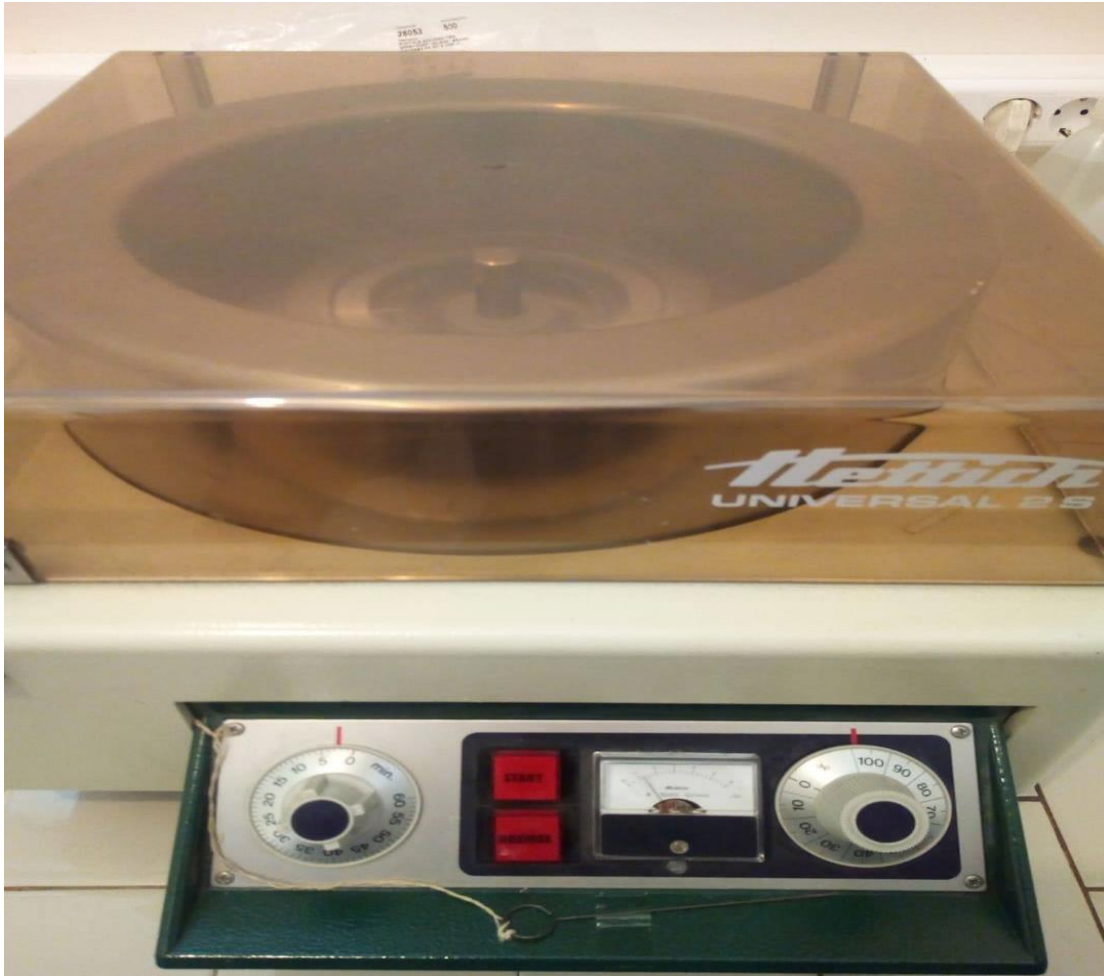
Εικόνα 4: Φυγόκεντρος η οποία περιστρέφεται με 300 rpm για χρονικό διάστημα 5 minutes και τα δείγματα θα πρέπει να έχουν ίδια ποσότητα για την καλύτερη λειτουργία της.
