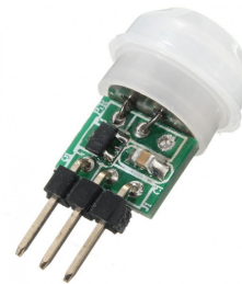
Εικόνα 43: Αισθητήρας κίνησης PIR
