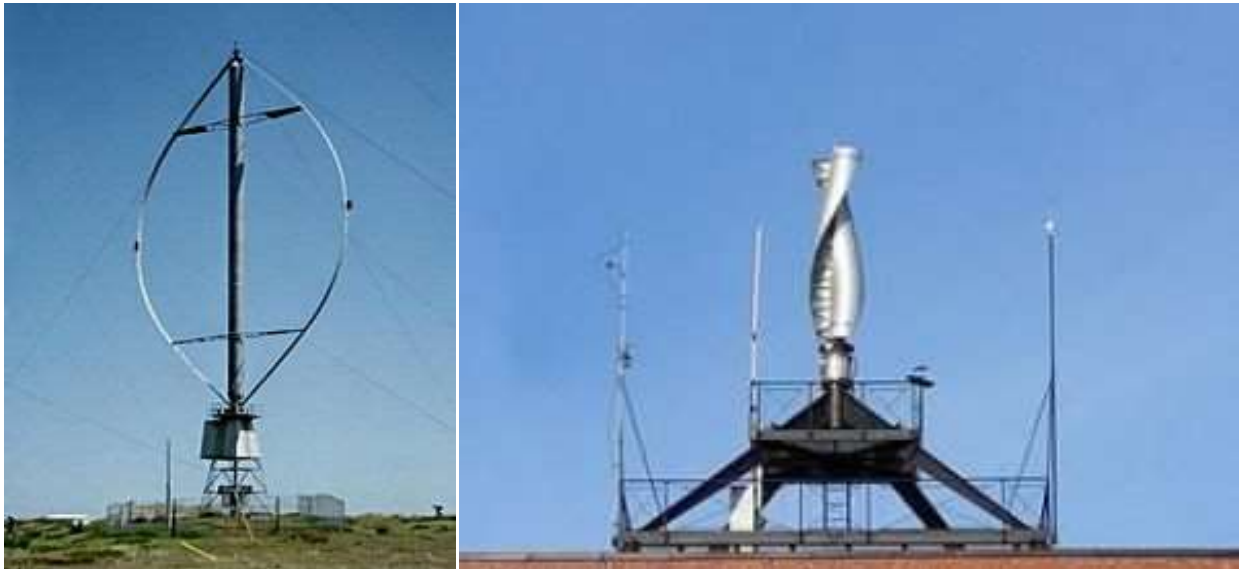
Σχήμα 15:(α) Darrieus ανεμογεννήτρια, (β)Savonius ανεμογεννήτρια.
