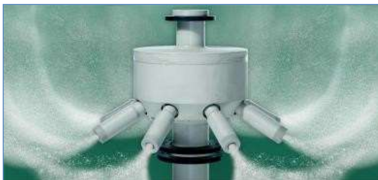
Εικόνα 1.15: Τζιφάρια Αερισμού Λυμάτων.
