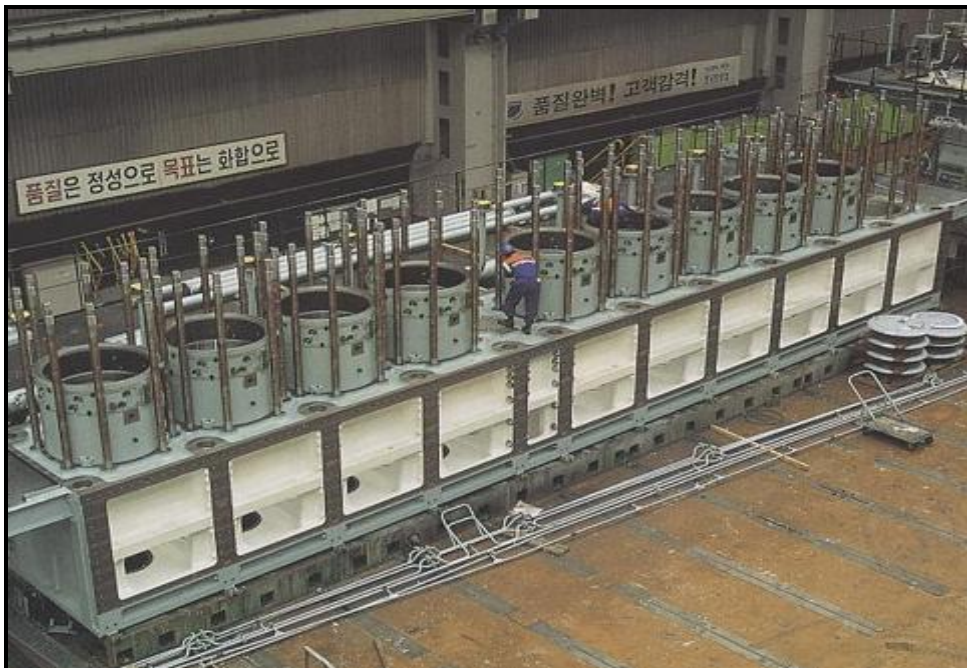
Εικόνα 4.26: Το μπλοκ μαζί με τα χιτώνια τοποθετημένο πάνω στο πλαίσιο. ( http://www.marinediesels.info )
