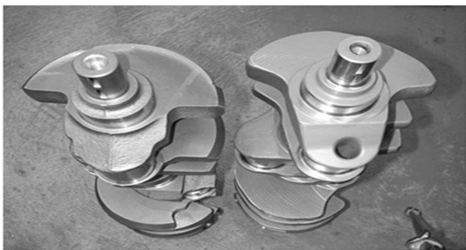
Σχ. 2.8: Σφυρηλατημένο (αριστερά) και χυτευμένο (δεξιά) στοιχείο στροφαλοφόρου. [16]
