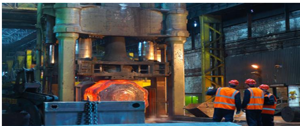
Σχ. 2.1: Το μέταλλο διαμορφώνεται με συμπιεστικές δυνάμεις που παρέχονται από μια μηχανή σφυρηλάτησης. [13]
