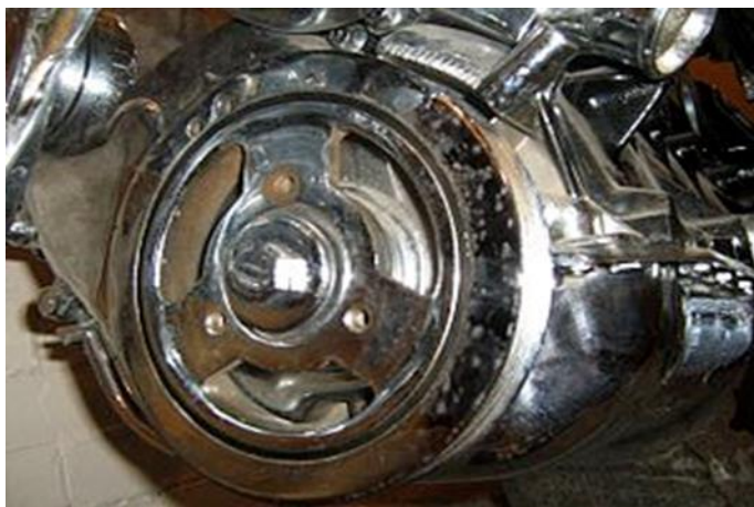
Σχ. 2.7: Ο αρμονικός αποσβεστήρας σε μια τετρακύλινδρη μηχανή. [16]
