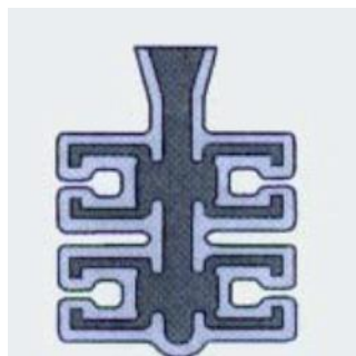
Σχ. 3.15: Αποπερατωμένος τύπος μαζί με τον κορμό και τα κέρινα πρότυπα για χύτευση ακριβείας. [29]
