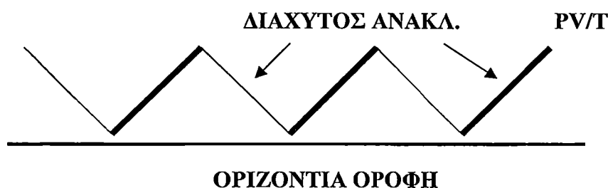
Εικόνα 28 Σύστημα PV/T με διάχυτους ανακλαστήρες
