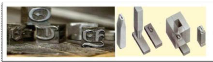
Εικόνα 12: Αριστερά: Διάφορα κινητά μεταλλικά τυπογραφικά στοιχεία. Δεξιά: Χαρακτηριστική απεικόνιση των σταδίων δημιουργίας κινητών τυπογραφικών μεταλλικών στοιχείων.
