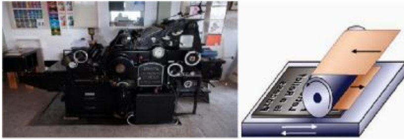
Εικόνα 12: Αριστερά: Επίπεδο πιεστήριο Heidelberg. Δεξιά: Σχηματική απεικόνιση επίπεδης τυπογραφικής μηχανής. Πηγή: http://s.kathimerini.gr/resources/2016-03/21--2-thumb-large.jpg , http://graficnotes.blogspot.gr/2014/06/offset.html .
