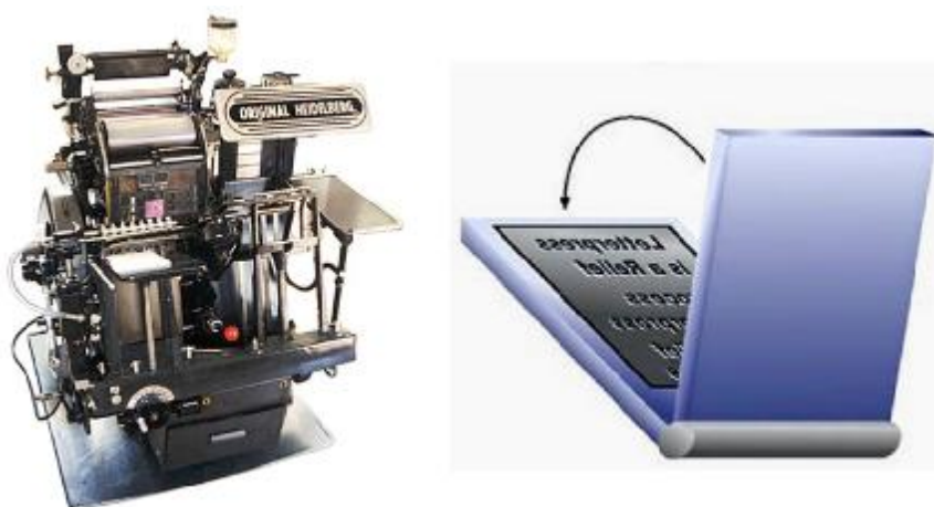
Εικόνα 11: Αριστερά: Όρθια τυπογραφική μηχανή της Heideberg. Δεξιά: Σχηματική απεικόνιση όρθιας τυπογραφικής μηχανής. Πηγή: http://graficnotes.blogspot.gr/2014/06/offset.html
