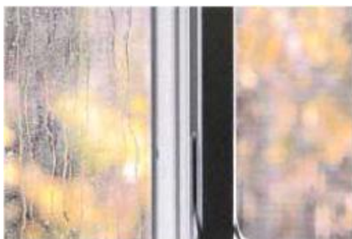
Εικόνα 2- 14 Ο αυτοκαθαριζόμενος υαλοπίνακας με επικάλυψη διοξειδίου του τιτανίου απομακρύνει το νερό της βροχής, σε αντίθεση με έναν συμβατικό
