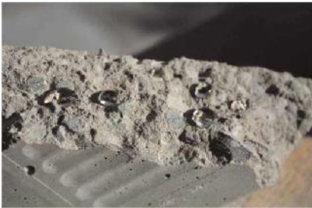
Εικόνα 2- 3 Χάρη στη νανοτεχνολογία, το σκυρόδεμα δεν απορροφάει τις σταγόνες του νερού, αυξάνοντας έτσι την αντοχή του και εμποδίζοντας την εμφάνιση υγρασίας.
