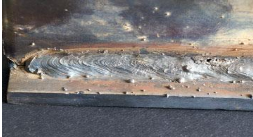
Εικόνα 4.9.3: "Πιπίλισματα" κατά τη συγκόλληση. Πηγή: Makemoneywelding.com
