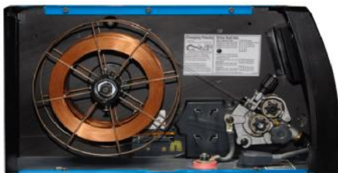
Εικόνα 4.9.2iv: Τροφοδοσία σύρματος σε μηχανή MIG/MAG Πηγή: google.com
