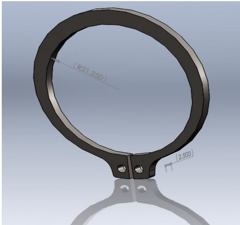
Εικόνα 5.9iv: Δακτύλιος συγκράτησης αξόνων των τροχών πλαγιοφορέα με εσωτερική διάμετρο 42,5mm κατά DIN 471.
