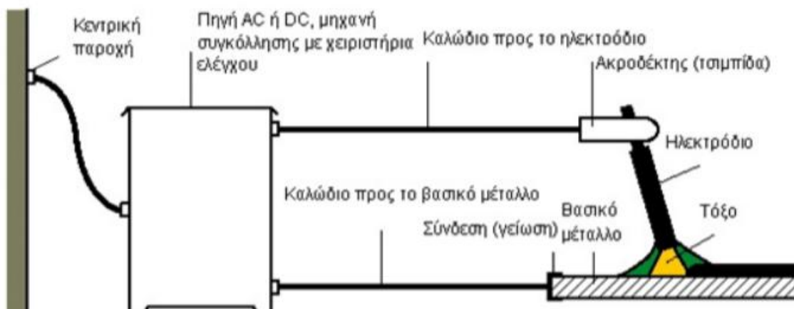
Εικόνα 4.9.2i: Συγκόλληση MMA Πηγή: google.com
