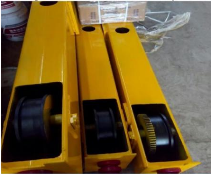
Εικόνα 4.5ii: Τροχοί των πλαγιοφορέων. Οδοντωτοί και απλοί. Πηγή: google.com
