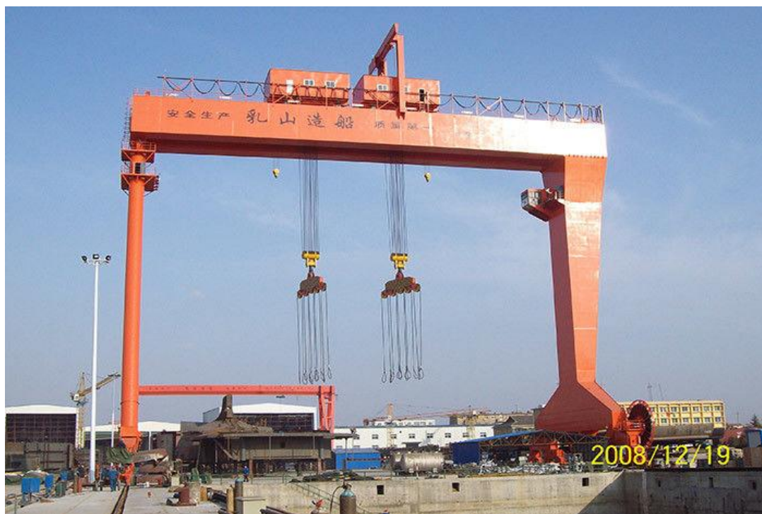
Εικόνα 2.4.1: Γερανογέφυρα ναυπηγείου με δυο φορεία.
