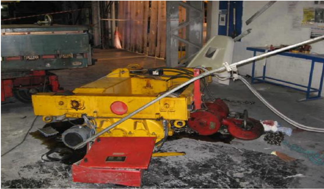
Εικόνα 3.1i: Υπερφόρτωση γερανογέφυρας. Πηγή: google.com
