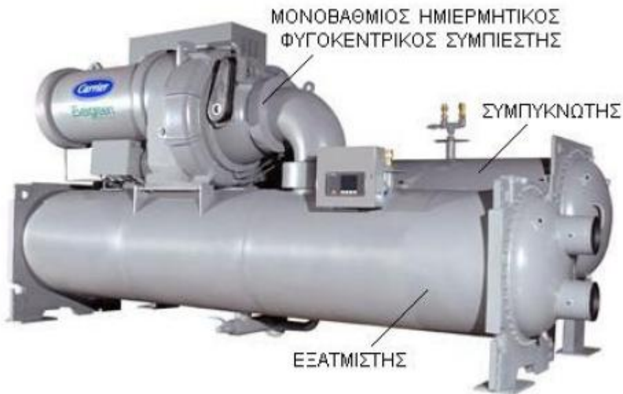
ΕΙΚΟΝΑ 2.5 Υδροψυκτος φυγοκεντρικός ψύκτης νερού με μονοβάθμιο ημιερμητικό φυγοκεντρικό συμπιεστή
