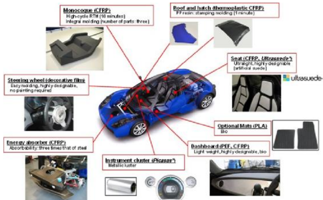
Εικόνα 1.8: Εφαρμογή σύνθετων υλικών στα αυτοκίνητα. 49
