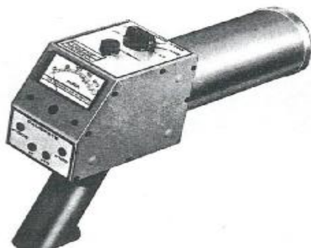
Σχήμα 7: Φορητό όργανο με θάλαμο ιονισμού διαστάσεων 2 7/8'' x 5 1/2'' και ευαίσθητου όγκου 580 cc
