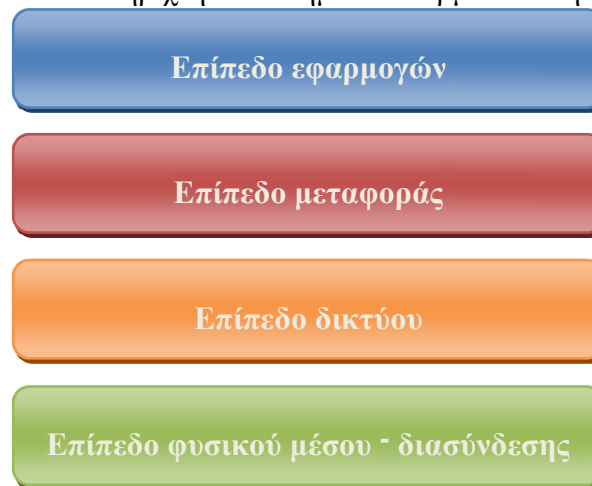
Εικόνα 1 Τα τέσσερα επίπεδα του προτύπου TCP/IP
