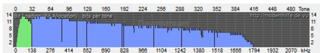
Εικόνα 47: Bit Loading (Bit Allocation) bits per tone στο router Thomson TG585V6
