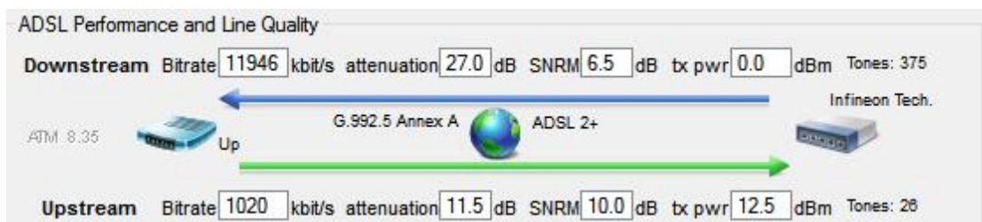
Εικόνα 46: Downstream & Upstream στο router Thomson TG585V6
