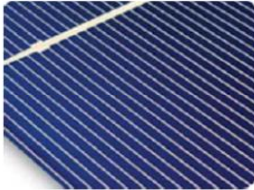
Εικόνα 3.3: Παράδειγμα Φωτοβολταϊκού πλαισίου Μονοκρυσταλλικού πυριτίου
