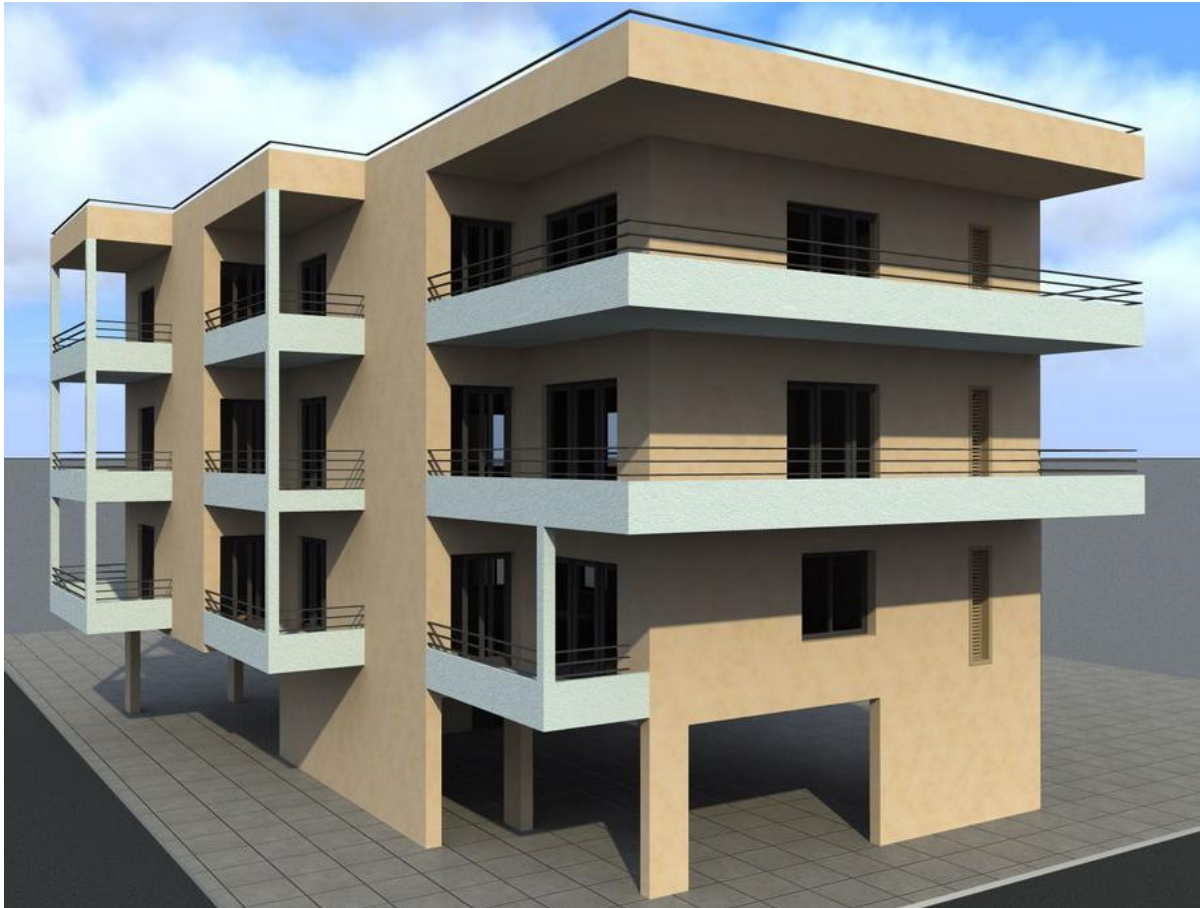
Σχήμα 1: Παράδειγμα κτιρίου με pilotis ( http://www.marneris.gr/parsant/ ).
