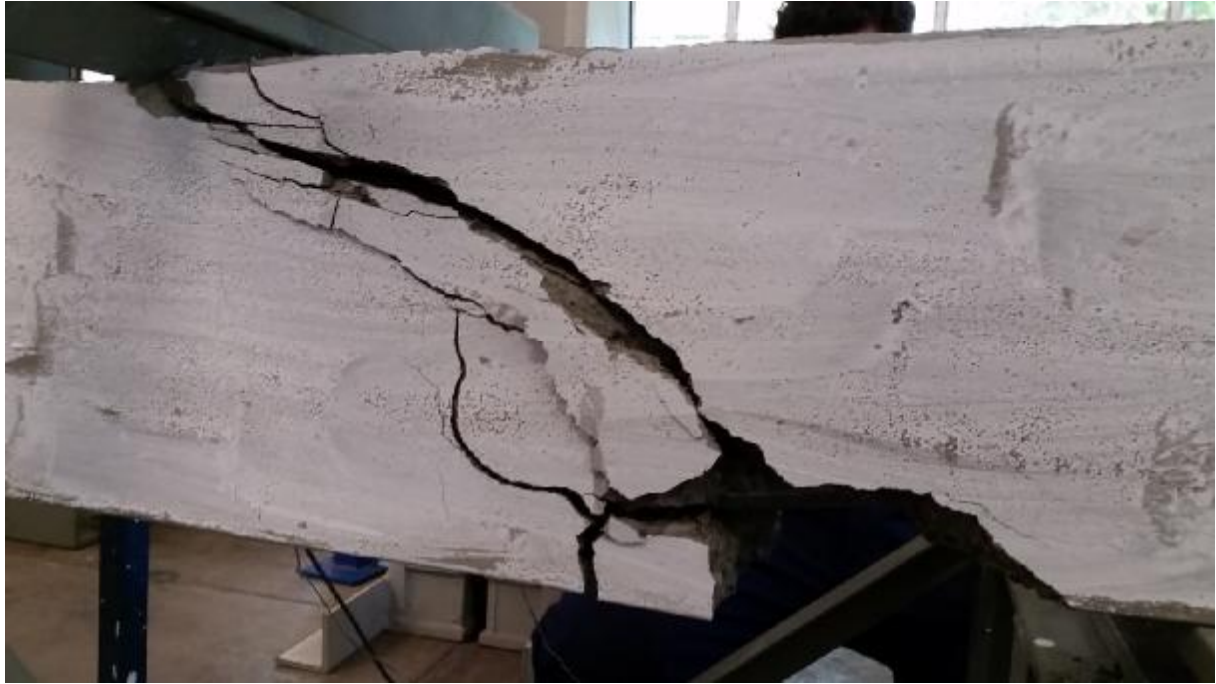
Σχήμα 8: Διατμητική αστοχία δοκού ( https://www.youtube.com/watch?v=zn3-VM9Eurw ).
