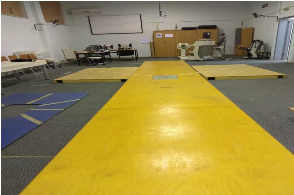
Εικόνα 11. Συνδιασμός ανάλυσης κίνησης 3D με δυναμοδάπεδο.
