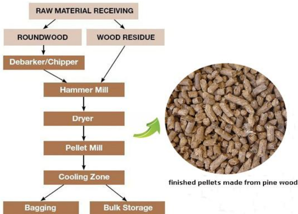
Εικόνα 4 Διαδικασία παραγωγής πέλλετ
