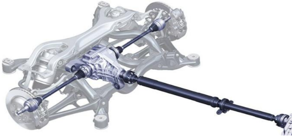
Εικόνα 49: Κεντρικός σωλήνας ωθήσεως [Πηγή: http://www.trucktrend.com/ ]
