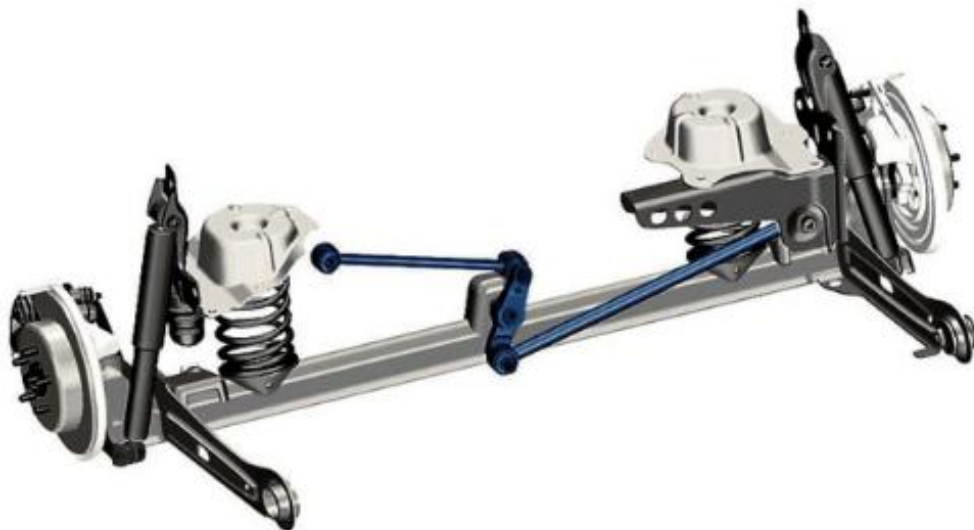
Εικόνα 15: Άκαμπτος άξονας. [Πηγή: https://www.autotriti.gr/ ]
