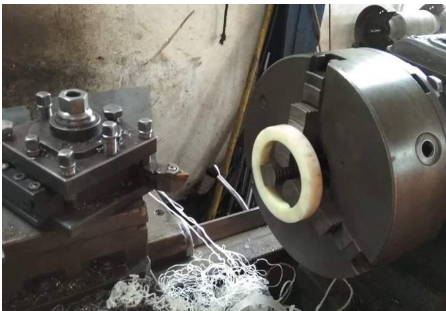
Εικόνα 42: Διαμόρφωση πάχους τεφλόν στα 18mm με την χρήση τόρνου.
