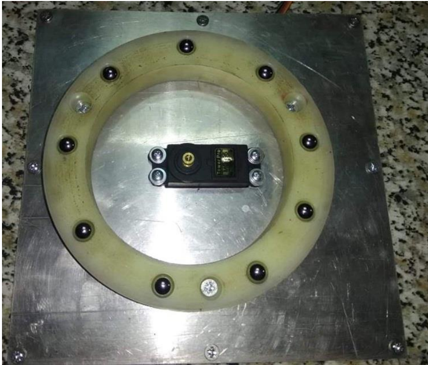
Εικόνα 58: Εγκατάσταση ρουλεμάν και σερβοκινητήρα στην σταθερή βάση.
