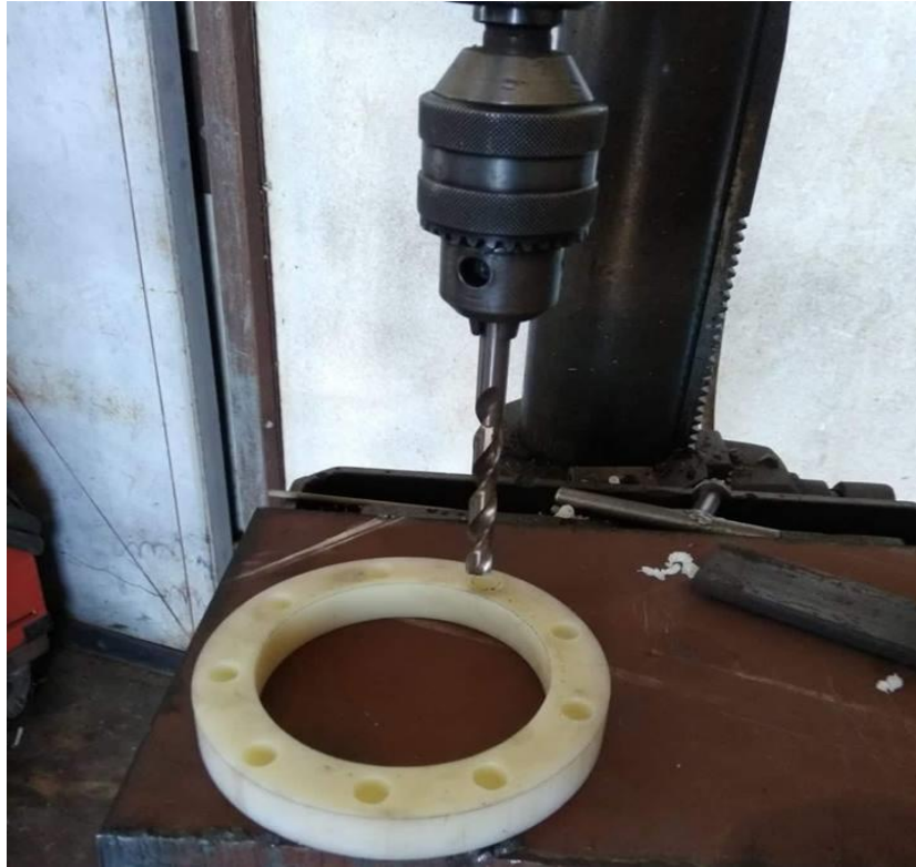
Εικόνα 43: Δημιουργία υποδοχών για τις σφαίρες με την χρήση σταθερού τρυπανιού.
