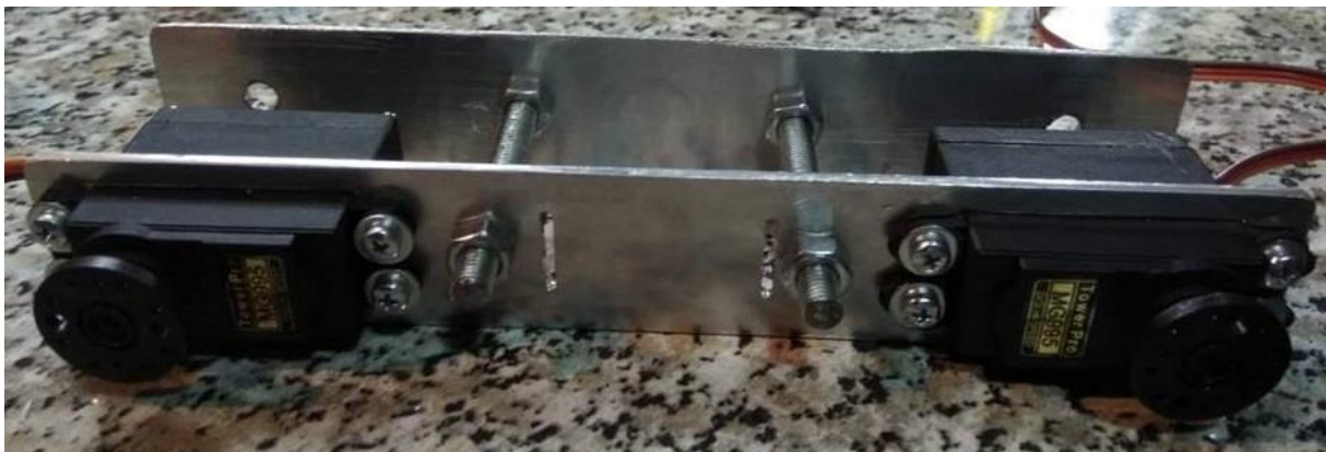
Εικόνα 64: Εγκατάσταση σερβοκινητήρων στον σύνδεσμο του αγκώνα.
