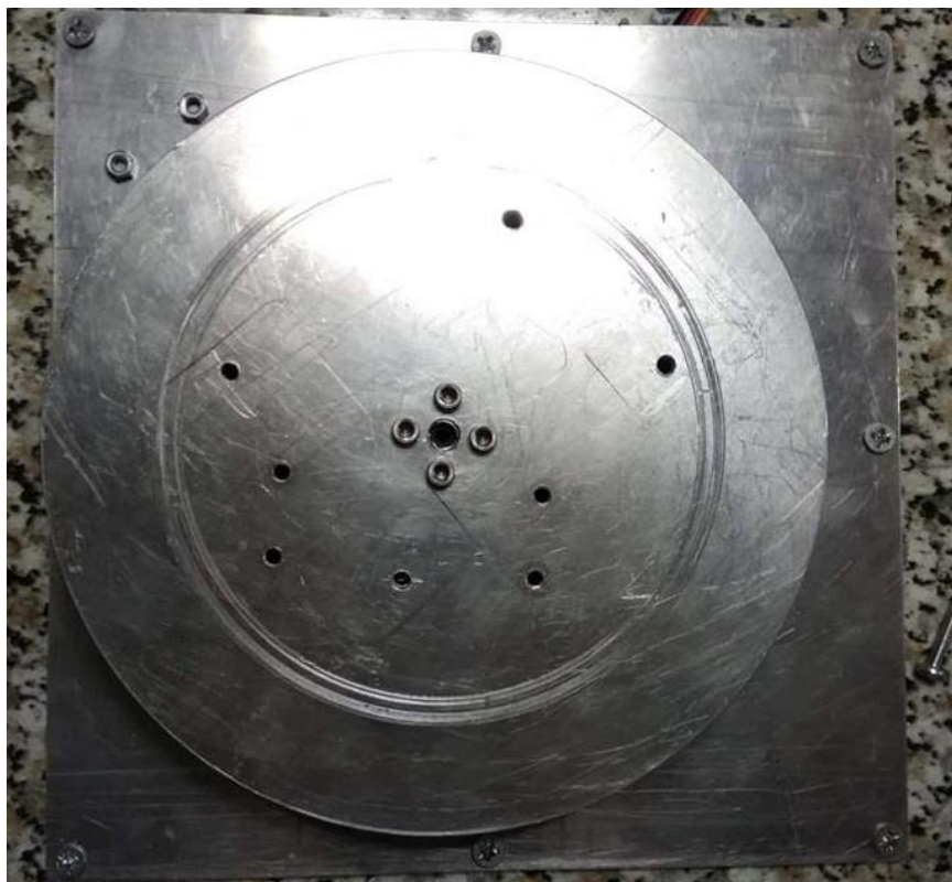
Εικόνα 59: Εγκατάσταση περιστρεφόμενης βάσης για την κίνηση του ώμου αριστερά-δεξιά.
