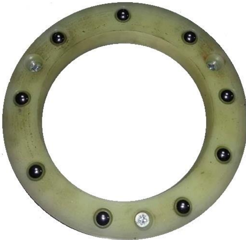
Εικόνα 44: Το ρουλεμάν ολοκληρωμένο.
