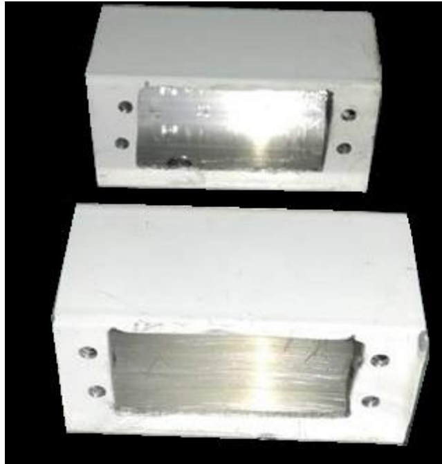
Εικόνα 45: Οι βάσεις των δύο σερβοκινητήρων που είναι υπεύθυνοι για την πάνω-κάτω κίνηση του ώμου.
