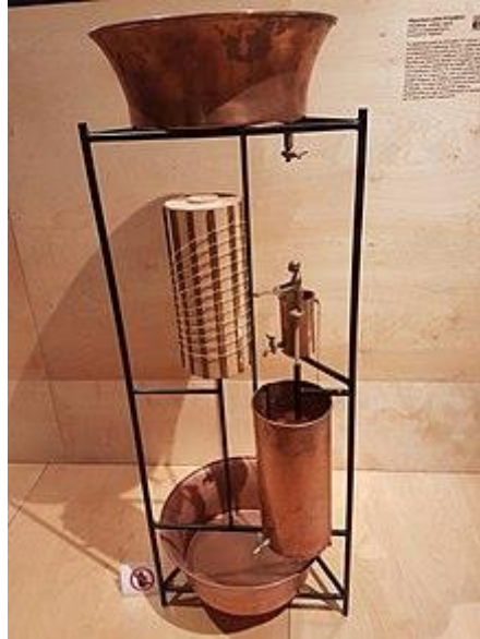
Εικόνα 4: Υδραυλικό ρολόι του Κτησίβιου, ανακατασκευή στο Τεχνολογικό Μουσείο Θεσσαλονίκης. (el.wikipedia.org)
