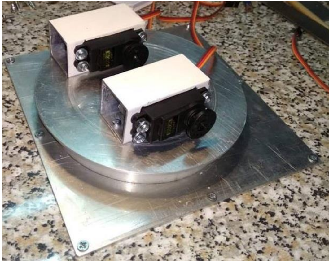
Εικόνα 61: Εγκατάσταση σερβοκινητήρων για την κίνηση του ώμου πάνω-κάτω.
