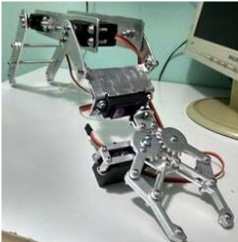
Εικόνα 68: Ένωση αρπάγης και σερβοκινητήρα αρπάγης με τον σερβοκινητήρα περιστροφής καρπού.
