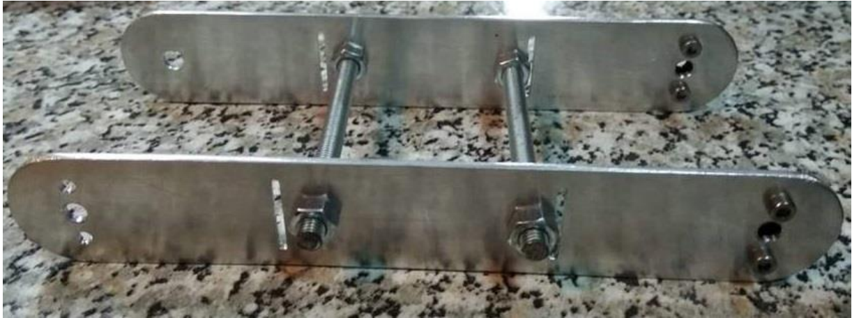
Εικόνα 62: Συναρμολόγηση συνδέσμου ώμου για την κίνηση πάνω-κάτω.
