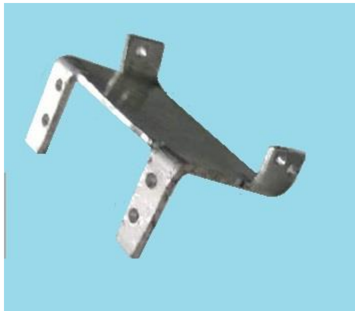
Εικόνα 46: Η βάση του σερβοκινητήρα που είναι υπεύθυνος για την κίνηση περιστροφής του καρπού.
