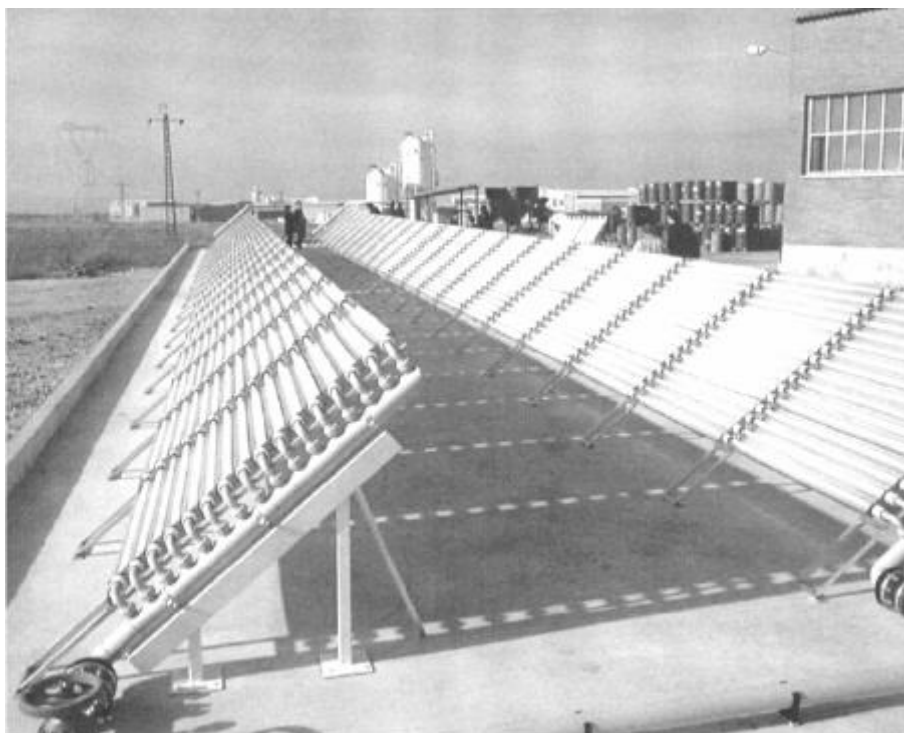
Οι παραβολικοί συλλέκτες (CPCs) που αναπτύχθηκαν για φωτοκαταλυτικές εφαρμογές.
