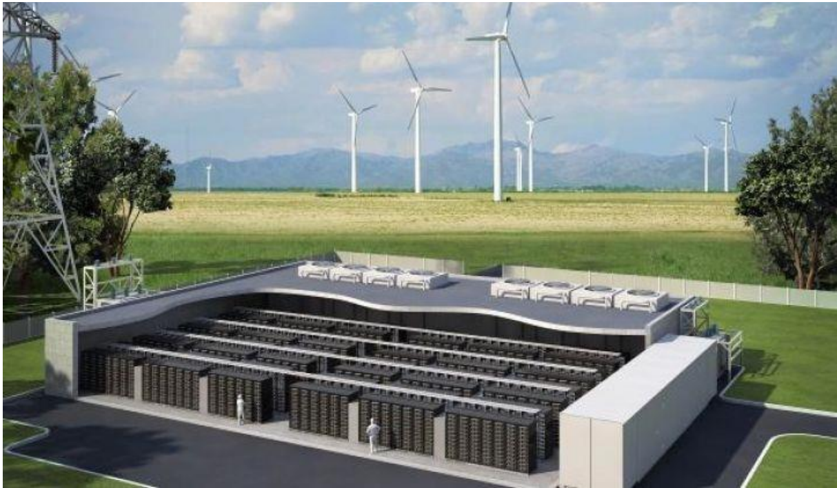
Εικόνα 4.5 Σταθμός Αποθήκευσης Ενέργειας με Μπαταρίες
