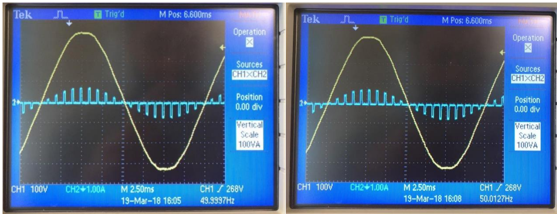
Σχήμα 5.1: Τάση εισόδου (κίτρινο) και ρεύμα εισόδου (μπλε) για επιθυμητή ισχύ: (α) 20 Watt και (β) 30 Watt με παλμοδότηση PWM.
