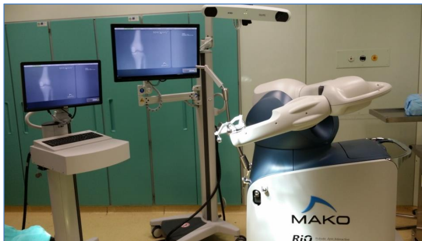
Εικόνα 2.2. Ρομποτικό Χειρουργικό Σύστημα MAKO - RIO® (τροποποιημένο από Metropolitan Hospital )
